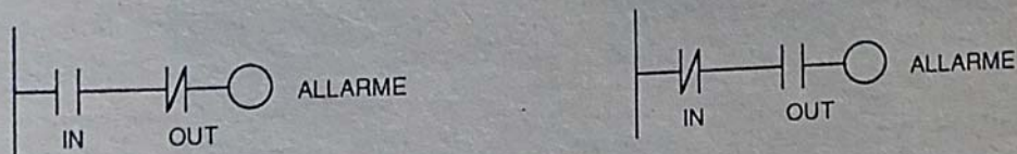
Fig. 13.61 - Serie software tra comando (IN) e uscita (OUT) pilotata.
